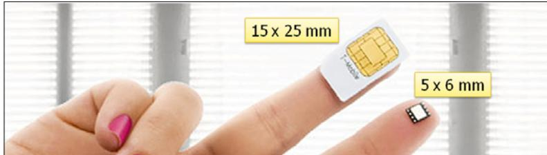
Bild 6: Mini-SIM-Karte und embedded SIM.
